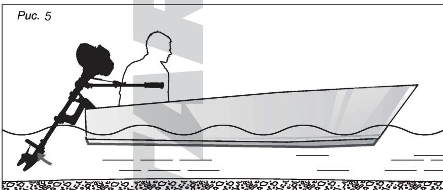
Поставьте ручку газа в положение холостого хода. Разверните мотор на 180° и добавьте оборотов для начала движения.
